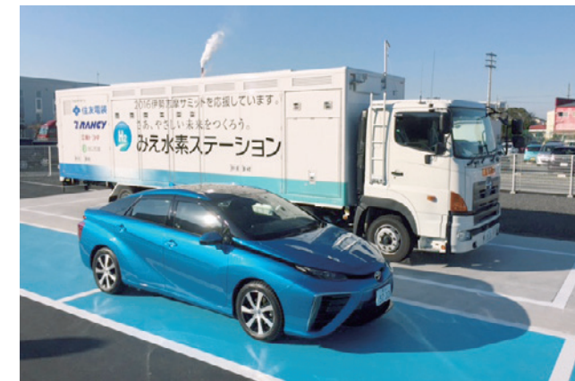
(奥)移動式水素ステーション (手前)燃料電池自動車
