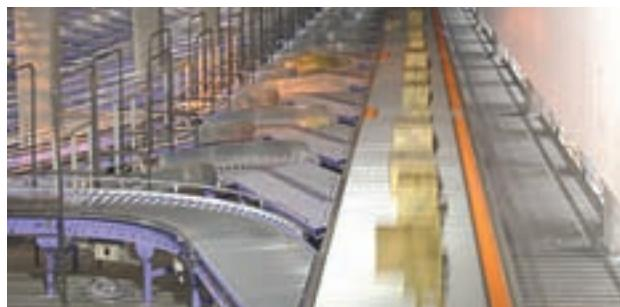
物流加工業務を支えるマテハン機器類\*。中でも、写真の最新型のソーター（高速仕分機）は1時間当たり16,000個のカートンを仕分けすることができます。
