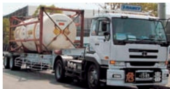
当社では、合成樹脂、消費財など、通常の荷姿（紙袋、フレコン、カートン等）に加え、写真のように、液体専用のタンクコンテナ（主にケミカル品）も輸送しております。
