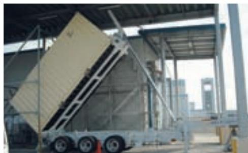
写真はシャーシの設備によりコンテナをリフトアップすることができるハイリフターシャーシでの作業の様子。
