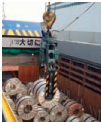
写真は鋼板の荷役作業の様子。四日市港では、鉄鋼関連も重要な取扱貨物のひとつとなっており、年間12万9千トンを超える荷役を行っております。
